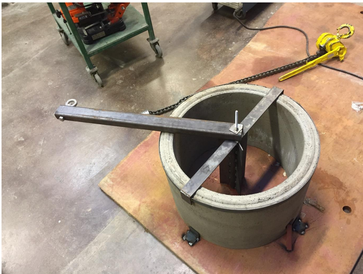
Figur 80: Oversikt over forsøksoppsett. Jekken festes i øyebolten på armen som påfører moment på vingene på sylindren nede i betongringen. Når armen beveges vil prøvestykket rotere. Fastsveising av betongringen synes nede til høyre.
