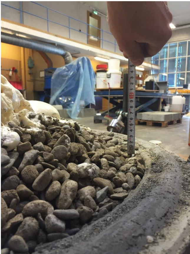
Figur 86: Ekspansjonen i PU-skummet presser opp omfyllingsmassene i forsøk 2
