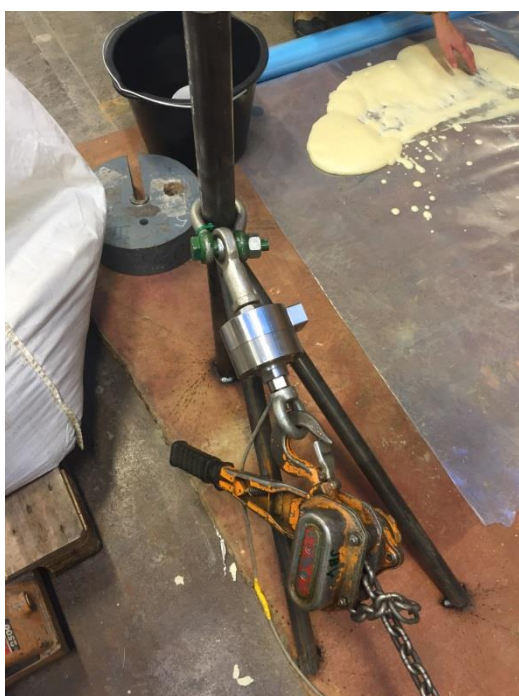
Figur 79: innfesting av lastcelle og manuell jekk i samme plate som betongringen er sveiset fast til
