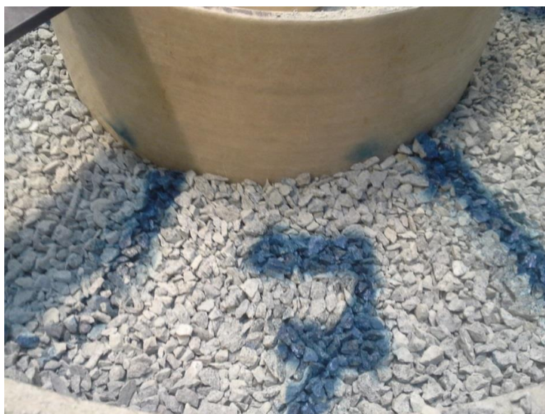
Figur 96: Bruddanvisning forsøk 7 GRP
