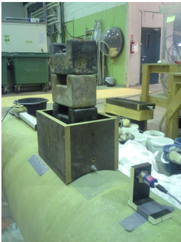
Figur 46: t.v forsøk er gjennomført, bilde tatt før demontering. Legg merke til lodd og det tynne laget med finmasser som ligger igjen på røret. t.h:sylinder og kasse montert på GRP-rør.
