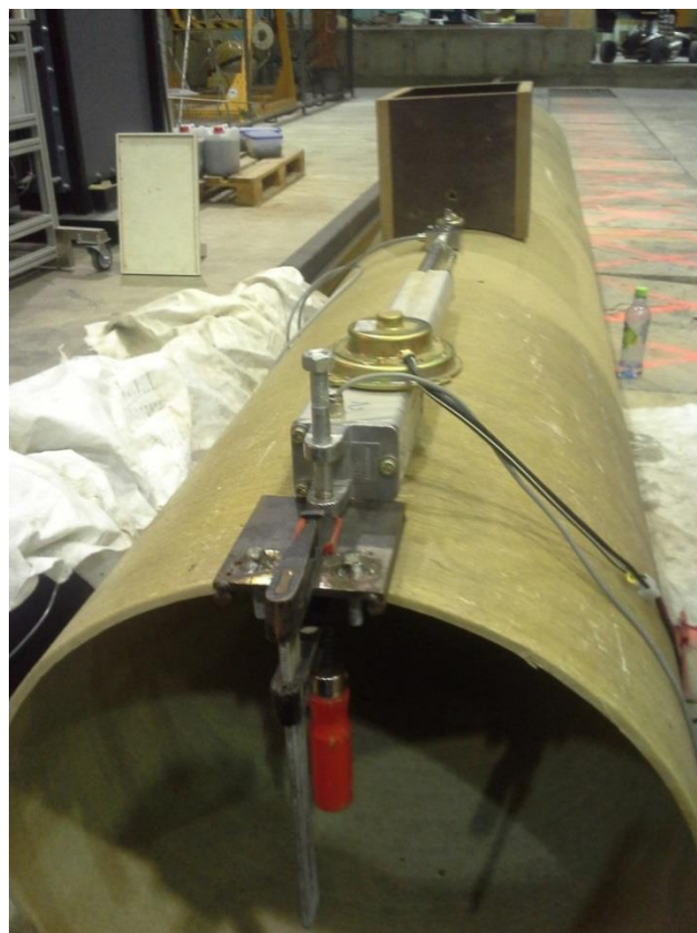
Figur 46: t.v forsøk er gjennomført, bilde tatt før demontering. Legg merke til lodd og det tynne laget med finmasser som ligger igjen på røret. t.h:sylinder og kasse montert på GRP-rør.
