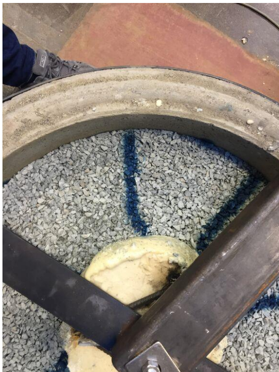
Figur 90: Bruddanvisning i massene forsøk 4. Fig. til høyre: eksempel på ujevnheter i overflaten av sylindren
