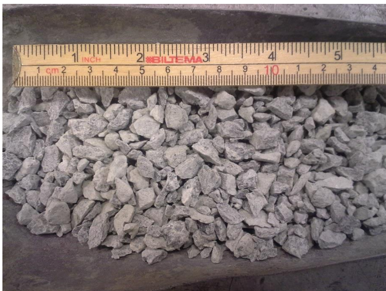
Figur 64: 4-8 mm knust pukkbrukt i forsøk 4-7, kornform
