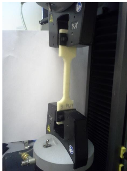
Figur 68: Kjøring av strekkprøve i prøvemaskin på materialteknik laboratorium NTNU
