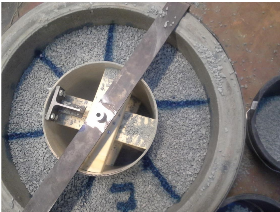
Figur 81: Oppsett for GRP-rør i samme testrigg
